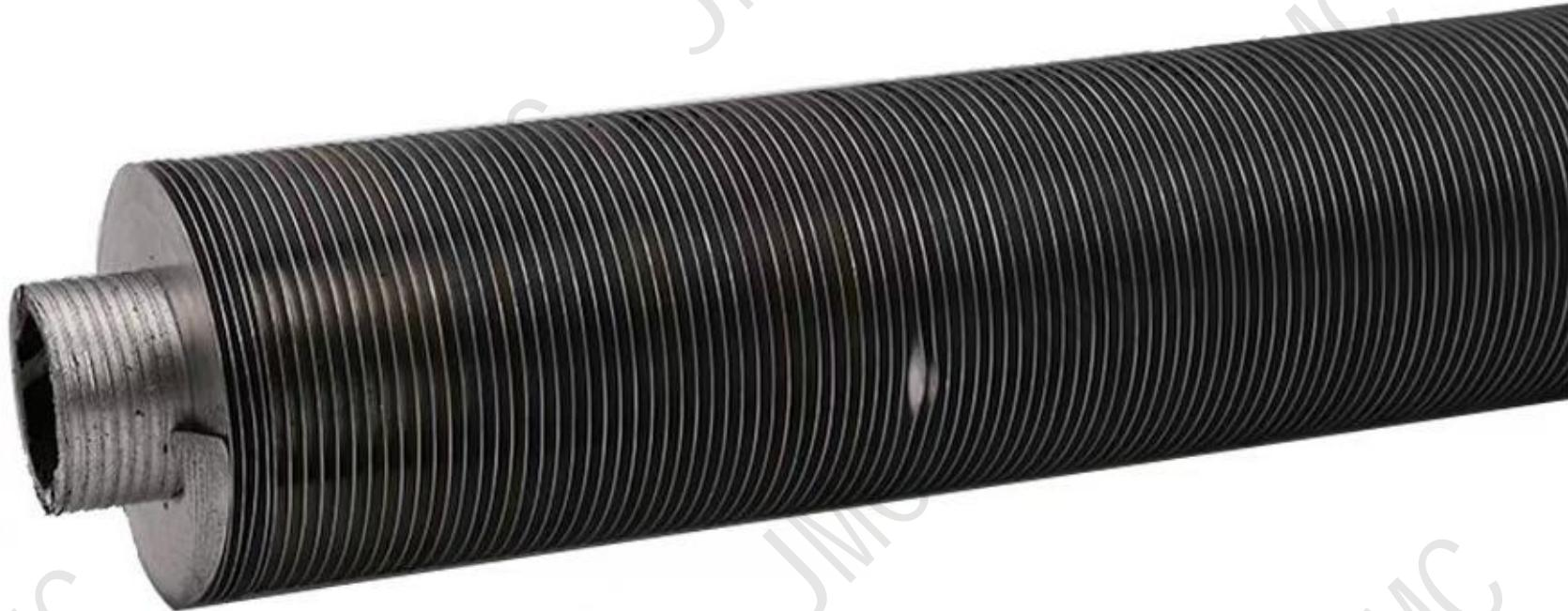
翅片管散热器一般用于加热或冷却空气，具有结构紧凑，单位换热面积大等特点。广泛应用于纺织，印染，石油，化工，干燥，电力等各个领域。
